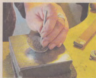
Die Schmuck-Steelpan erhält einzelne Tonfelder.
