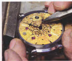
Werkteile des 18. Jahrhunderts, Zifferblatt mit Schweizer Automatik-Uhrwerk
